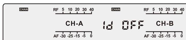
备注：由于本套系统采用是每个频点都有各自的加密算法，因此，主机只能和最后一次对频成功的手咪才能使用，如果出现，手咪和主机显示的频点都一样，但是主机有信号没有声音，重新进行一次红外对频操作即可。
